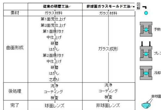
図 開発した非球面ガラスモールド工法と従来の研磨工法の比較
