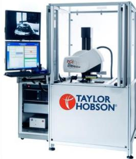
接触式三次元非球面形状測定機
