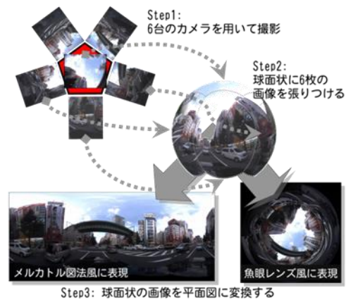
パノラマ画像生成の主な流れ (実際には Step2 と Step3 の区別はありません)
